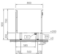
Electrical inlet (power) Equipotential screw
